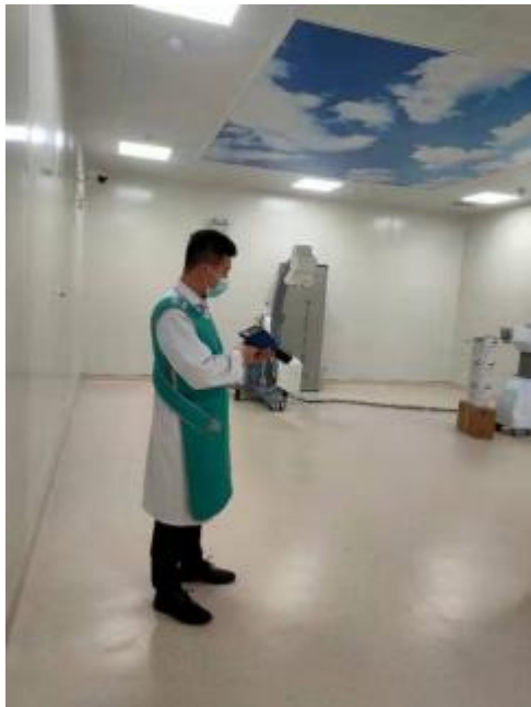
紧急回源后对周围剂量进行检测
